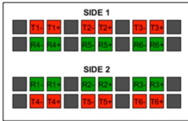
Figure 11 - Checkerboard (2 Row or Edge Card)
