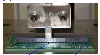
INSULATOR PLASTIC LOCKING CLIPS NOT TOUCHING BOARD FULLY SEATED
